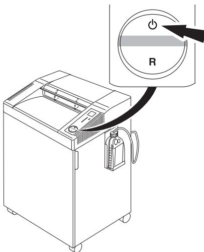
**DE** Autom. Standby - Abschaltung nach 15 Minuten. Maschine kann jederzeit durch Drücken des P Schalters ausgeschaltet werden. Grüne Kontrollleuchte R erlischt. Danach verbraucht die Maschine keinen Strom mehr. Innerhalb dieser 15 Minuten verbraucht der Aktenvernichter folgende Wh Energie.
